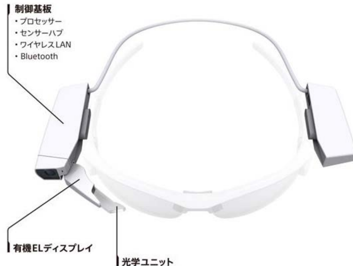
片眼用ディスプレイモジュール（開発品） （画像左側：ディスプレイ表示部、右側：バッテリーなど）
