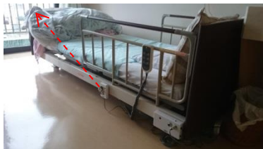
V12型: 足を出した時に通報、介助時自動でセンサーがOFF、介助終了後自動ONする機能搭載
