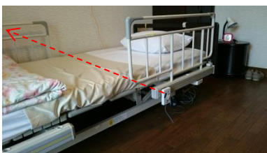
V50JB型: 足を出すすと通報、光ビームの 取り付けで、起き上がり、通過 検知もできるヒット商品
