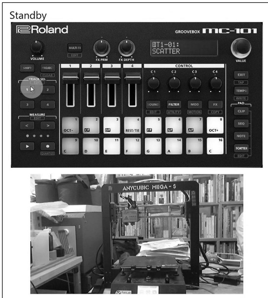
図 4. マウスジェスチャ用アプリの GUI。上側 (MC-101 表示側) でマウスジェスチャを認識し、下側 (USB カメラ表示側) で 3D プリンタの動作の様子を観察する。マウスポインタ周辺のは MC-101 の直上にある 3D プリンタのノズルの現在位置を指す。
