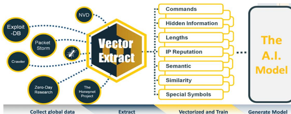
図6. 大量の 익스プロイトから特徴を抽出し、 익스プロイトを構成する要素を学習、推論
